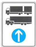
obilazan smjer za određene vrste vozila
